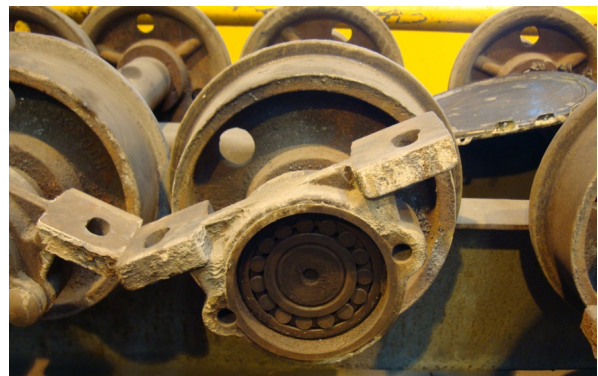
↑ Ruedas de las Vagonetas de una Autoclave
