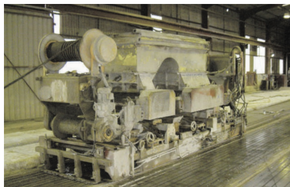
↑ Máquina para Instalación de Suelos de Hormigón
